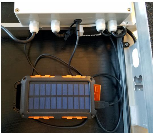
En cas de décharge complète de la batterie (rucher très ombragé ou végétation pendant plusieurs mois devant le panneau solaire) ; il est possible de recharger la batterie via un connecteur USB-C (avec une batterie externe, banque solaire ou chargeur USB 5V: identique à ce que vous utilisez pour recharger un smartphone). La batterie peut se recharger à la miellerie ou sur le rucher. La recharge peut se faire balance éteinte ou allumée, comme un smartphone..
